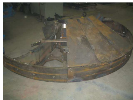
Paroi de broyeur à boulets
